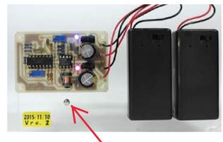
工学部 電子システム工学科では、3年前期に小型磁気浮上装置の製作を行います。小さな金属球が電磁石の力で空中に静止するという、興味深い結果を達成できる実験です。その様子は! ?こちらからご覧ください。
