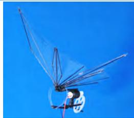
アゲハチョウの飛翔メカニズムを応用した、手のひらに乗るほどの大きさの蝶型はばたきロボットを開発。超小型のアクチュエータやバッテリー、カメラ、センサなどを搭載し災害現場での観測システム、広域に飛翔させ情報収集を図るロボットシステムなど、様々な場面での活用が期待されます。
