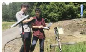
長野県小谷村、KCCSモバイルエンジニアリング(株)と連携し、エリアネットワークを利用した水田監視システムの実証実験を行っています。水位を計測するセンサからデータを収集し、Webの閲覧、メールへの送信を行い水位の見守りを行うシステムは、忙しい兼業農家の方々の省力化を目的としています。
