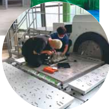
高加速度振動台での実験
