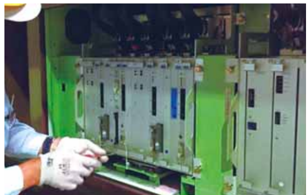
研究の提案法を実装した自動列車運転装置の取り付け
