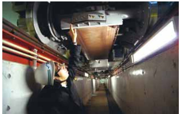
実証実験前の現地調査の様子 (回転モータではなく、リニア誘導モータ駆動式の鉄道車両)
