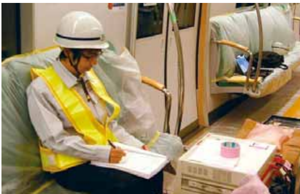
試運転試験での鉄道車両内測定中の様子
