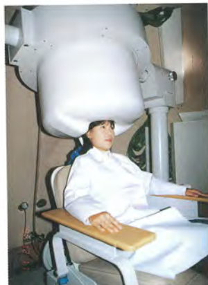
COSMOSの室内中央にはSQUIDシステムが設置されている。写真はSQUIDによる脳磁界計測の様子を示す
