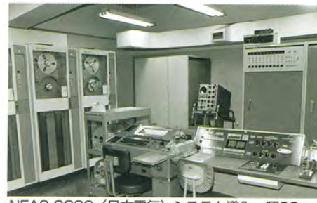
NEAC 2230(日本電気)システム導入 昭38
