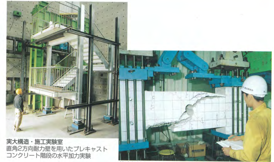
構造部材実験室 鉄筋コンクリート有孔ばりのせん断破壊実験
