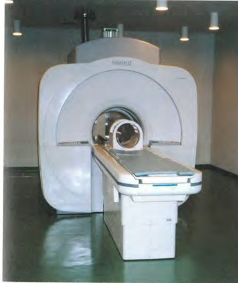
MRI（磁気共鳴画像装置） 高性能超電導磁石を用い、人体の断面像を無侵襲（傷つけず）に撮影する装置
