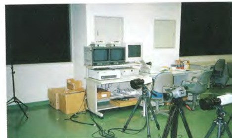
3次元運動解析装置 人間の動きをカメラで撮影し、3次元空間での運動として計測、解析する
