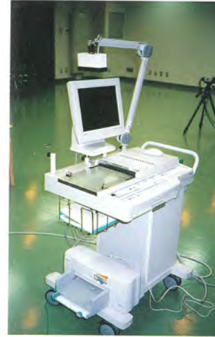
脳波計 様々な状況下での脳の活動状況を電氣的に計測
