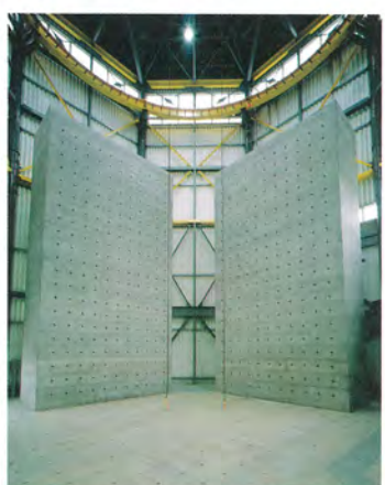
直角2方向耐力壁 (建設技研)
