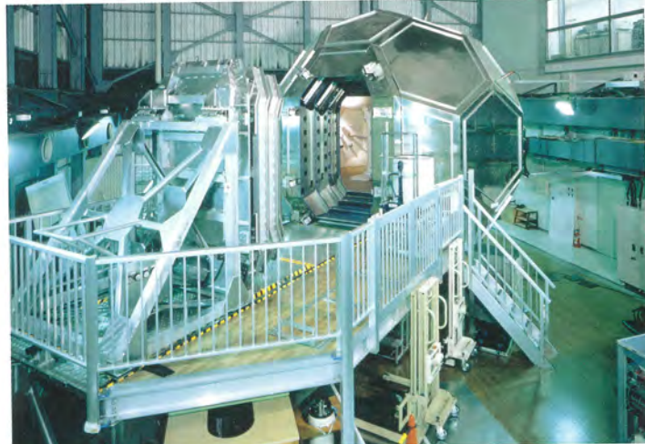
超高性能磁気シールドルーム（愛称「COSMOS」） 32面体形状をなし、4層のパーマロイ合金と1層のアルミニウム板からなる多重隔壁で構成されている
