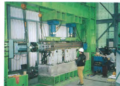
構造部材実験室 加力フレームを用いた鉄筋コンクリート壁の水平加力実験
