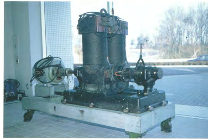
●トーマス・A・エジソン「エジソンダイナモ」、エジソン形直流発電機 1879年に発明し、自らエジソン社を創立、この機械を製造した。現存しているのは東大、国立博物館、東京理科大と本学の4台であり、しかも発電可能なものは本学の1台のみで、歴史的にも貴重なもの。（理工学部プレゼンテーションセンターに展示中）
