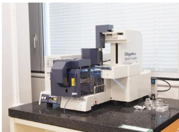
自動試料交換示差熱天秤システム (TG-DTA)
