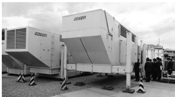
自揚型移動式高圧発電装置の外観
